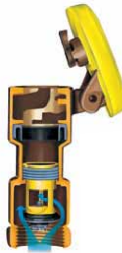
Vista transversal de una válvula de acople rápido
