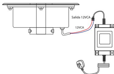
Localice las terminales de salida del transformador (12Vca) y conecte los dos cables de alimentación a su correspondiente tablilla de alimentación. Conecte los cables de el burbujeador a la tablilla de salida del transformador, puede colocarse en cualquier orden ya que no tiene polaridad. Asegúrese de que el interruptor de entrada se encuentre en la posición de APAGADO antes de la puesta en marcha. La unidad LED ya está lista para operar.
