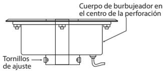
2. Afloje los tornillos que aseguran y nivelan el burbujeador, se encuentran en la parte inferior del mismo.
