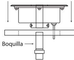
3. El cable del burbujeador, debe pasar en la dirección de las flechas, páselas por el orificio realizado en el primer paso, procurando guiar la boquilla por el centro del burbujeador.
