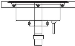
4. Para un mejor sellado puede aplicar sellador entre el burbujeador y el área a instalar (si es posible use los tornillos del burbujeador para sujetar el burbujeador a la boquilla).
