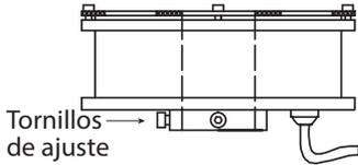
1.- Retire los tornillos de fijación en la parte inferior del burbujeador, para dejar los tornillos al ras con el anillo interior del cuerpo del burbujeador.
