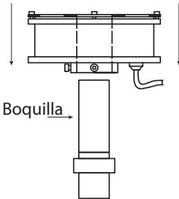
2. Coloque el orificio del burbujeador sobre la boquilla en la dirección de la flecha.
