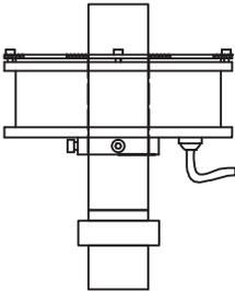
3. Apriete los tornillos de fijación en la parte inferior del burbujeador.
